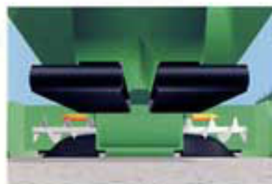
下層用ホッパから改質アスファルト混合物が、わだち発生部に供給されます。
